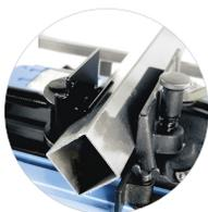
**SYSTÈME DE SERRAGE PRISMATIQUE POUR TUBES CARRÉS INCLUS**
