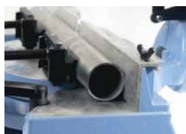
**Système de fixation „K“ pour tubes Ø 1 1/8" jusqu'à 2 3/4"**
