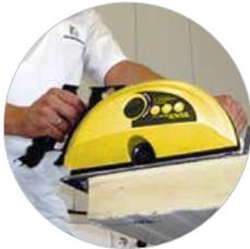
Coupe des panneaux sandwich, tôles et profilés d'épaisseur jusqu'à 3/8" (10 mm) et de profondeur 3 1/4" (82 mm)
