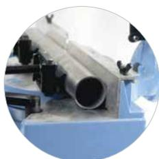
Avec système de fixation „K“ pour tube Ø 1 1/8" à 2 3/4" (30 à 70 mm)
